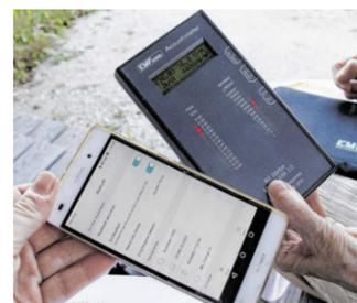
Bei Aktivierung von Bluetooth am Handy schlägt das Mikrowellen-Messgerät drastisch aus.
